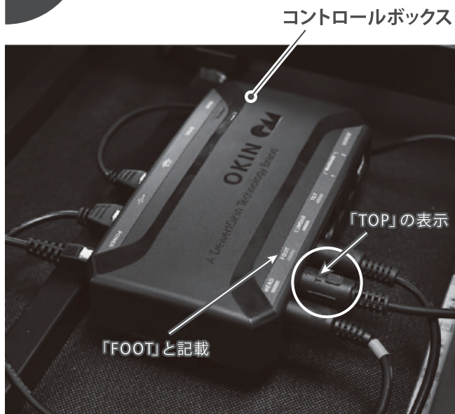
脚側のモーターのケーブルの接続箇所
